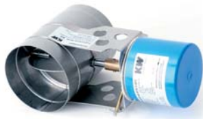
Typenreihe MOK... AD Für Geräte ohne Zündflamme, ohne Kondensatanfall, metallisch dichtschließend für Unterdruck-Abgasanlagen, bis 400° C. Gehäuse bis Ø 300 mm in steckbarer Ausführung.
