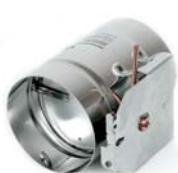
Typenreihe MOK Für Geräte mit Zündflamme und Festbrennstoffe mit Mindestöffnung für Unterdruck-Abgasanlagen. Für Abgastemperaturen bis 400° C.
