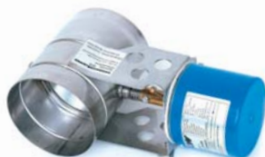
Typenreihe MUK Für Geräte ohne Zündflamme mit Kondensatanfall oder Kaskadenanlagen, metallisch dichtschließend, kondensatbeständig, für Über- und Unterdruck-Abgasanlagen bis 200° C. Bei Ausführung mit Dichtlippe bis max. 140° C. Mit druck- und kondensatdichter Wellendurchführung.
