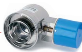
Typenreihe MUK 80/125, MUK 100/150 Für Abgasanlagen nach DVGW-Arbeitsblatt G 635 (LAS-Überdruck), Klappensegel mit aufgespritzter EPDM-Dichtung, bis 140° C. Druck- und kondensatdichte Wellendurchführungen.
